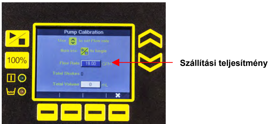
Ábra 27: Szivattyú kalibrálás (száll. telj. beállítása)
